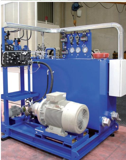
Sistema idraulico movimentazione stacker
