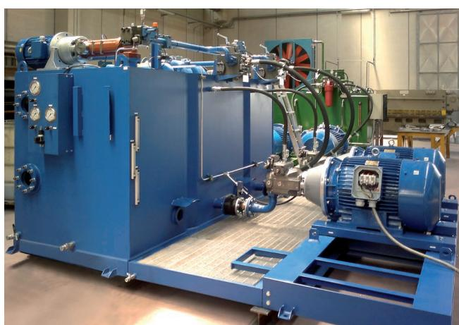
Centrale idraulica per banco testing
