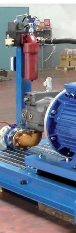
Centrale idraulica per forno ad arco elettrico
