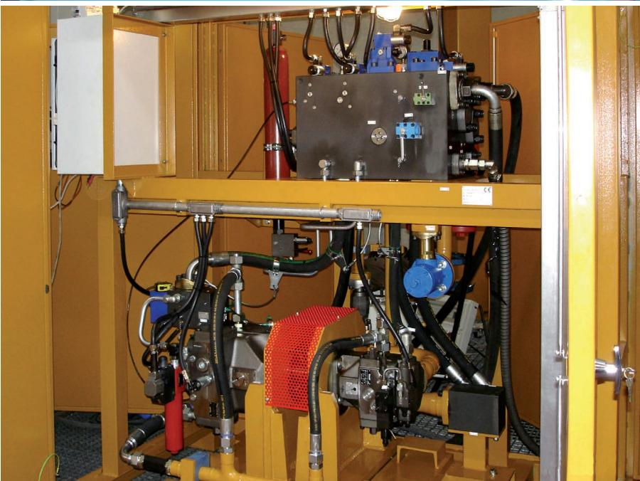
Banco valvole: manifold completo di struttura, per regolazione secondaria
